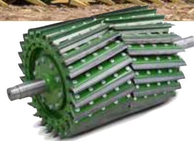
A „V” késelrendezésű szecskázódob 20, 28, 36, 40 vagy 48 késes is lehet. Mindegy, hogy 4 vagy 40 mm szecskahossz: minden lehetséges
