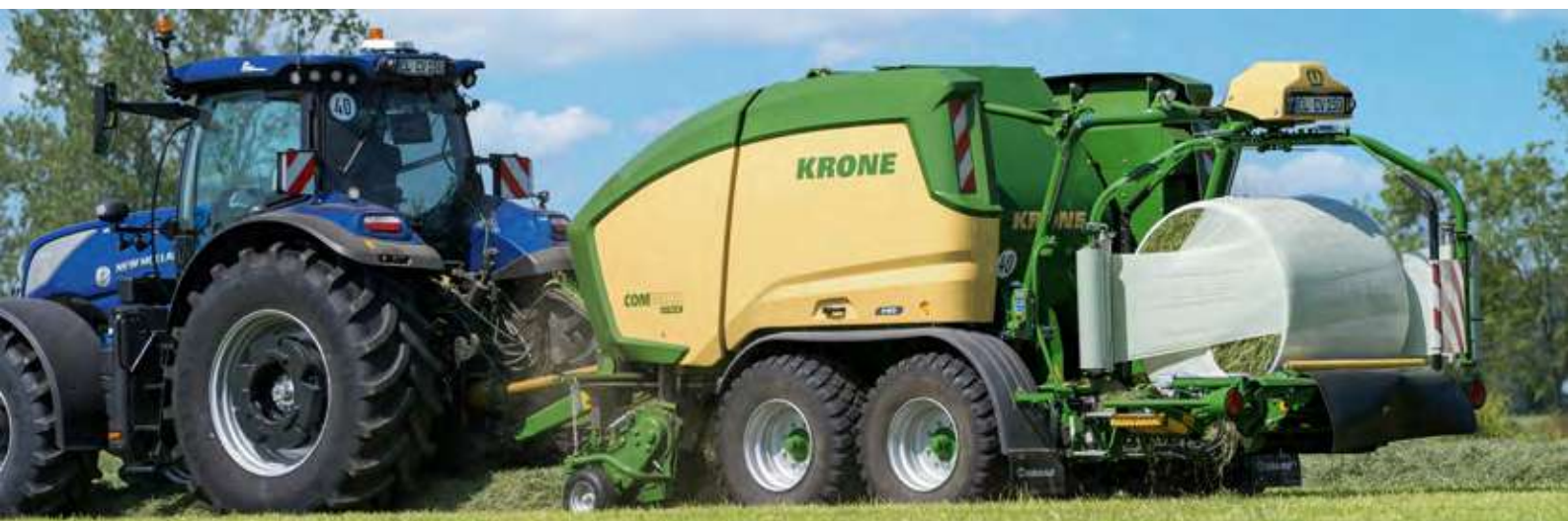
A dupla csomagolókar 36 min-1 fordulatszámmal rendkívül hatékony – ami összhangban van a bálázó nagy áteresztőképességével.
