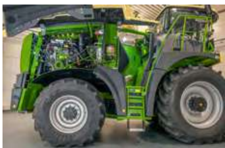
Könnyen megközelíthető, kól hozzáférhető főegységek, keresztbe beépített DEUTZ vagy LIEBHERR motor
