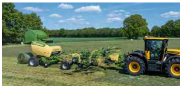
Az automatikus kiemeléssel, hátrameneti és kormányzási automatikával rendelkező KRONE AutoBale rendszer leveszi a traktorvezető válláról a komplex gépkombináció kezelésének terhet.
