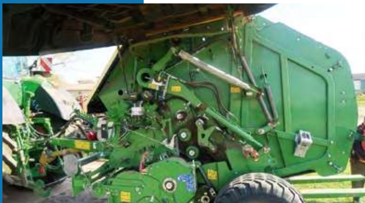
A Krone lecsökkentette a láncok számát
