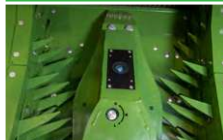
AutoScan optoelektronikus érettségfigyelő és automatikus szecskahossz szabályozó
