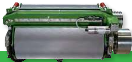
250 vagy 300 mm átmérőjű OptiMaxx szemroppantó, HD-BusaCLAD bevonattal, 30-50% fordulatszám különbséggel és VariQuick csererendszerrel
