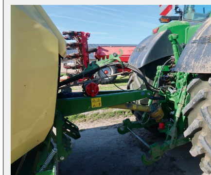
A traktor kardántengelyén adja át teljesítményét
