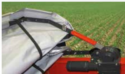
Elektromos, távműködtetésű takaróponyva
