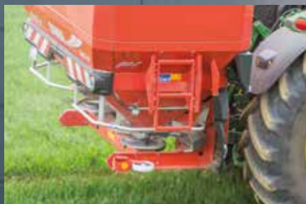
AXIS H – bal és jobb oldali szegélyszórás fordulatszám- és kirepítésipont-beállítással
