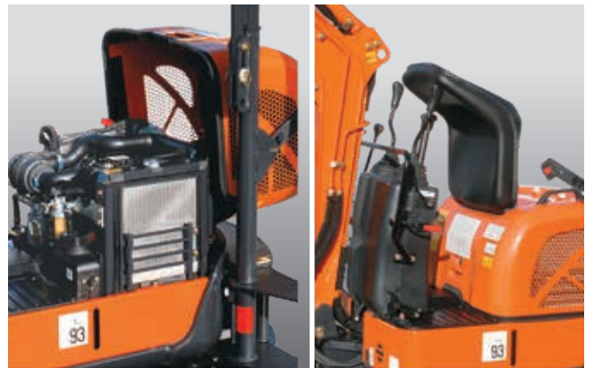
A szélesen nyíló fedelek megkönnyítik a karbantartást.
