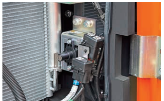
Az akkumulátorleválasztó kapcsolónak köszönhetően a karbantartás biztonságosan elvégezhető.
