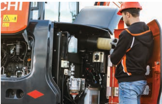
A napi vizsgálati pontok egymáshoz közel helyezkednek el, így az ellenőrzés kényelmesen végezhető.
