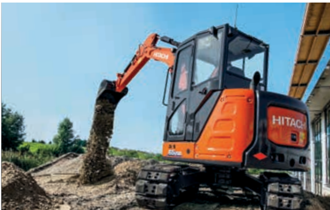
A ZX65USB-6 kis hátsó fordulási sugara miatt ideális a szűk helyeken történő munkavégzésre.
