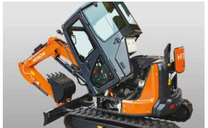
A dönthető padlónak köszönhetően a motor és a vezérlőszelap könnyen elérhető a gyors szervizeléshez.
