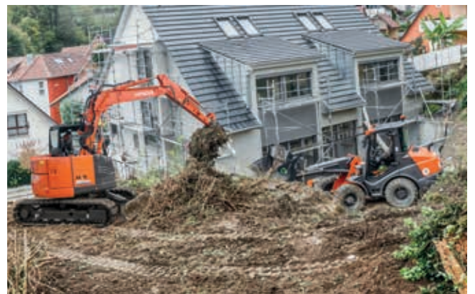
A ZX85US-6 kis hátsó fordulási sugara miatt ideális a szűk helyeken való munkavégzésre.
