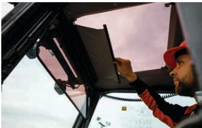
A napellenző csökkenti a tűző napfény zavaró hatását, és javítja a látási viszonyokat.
