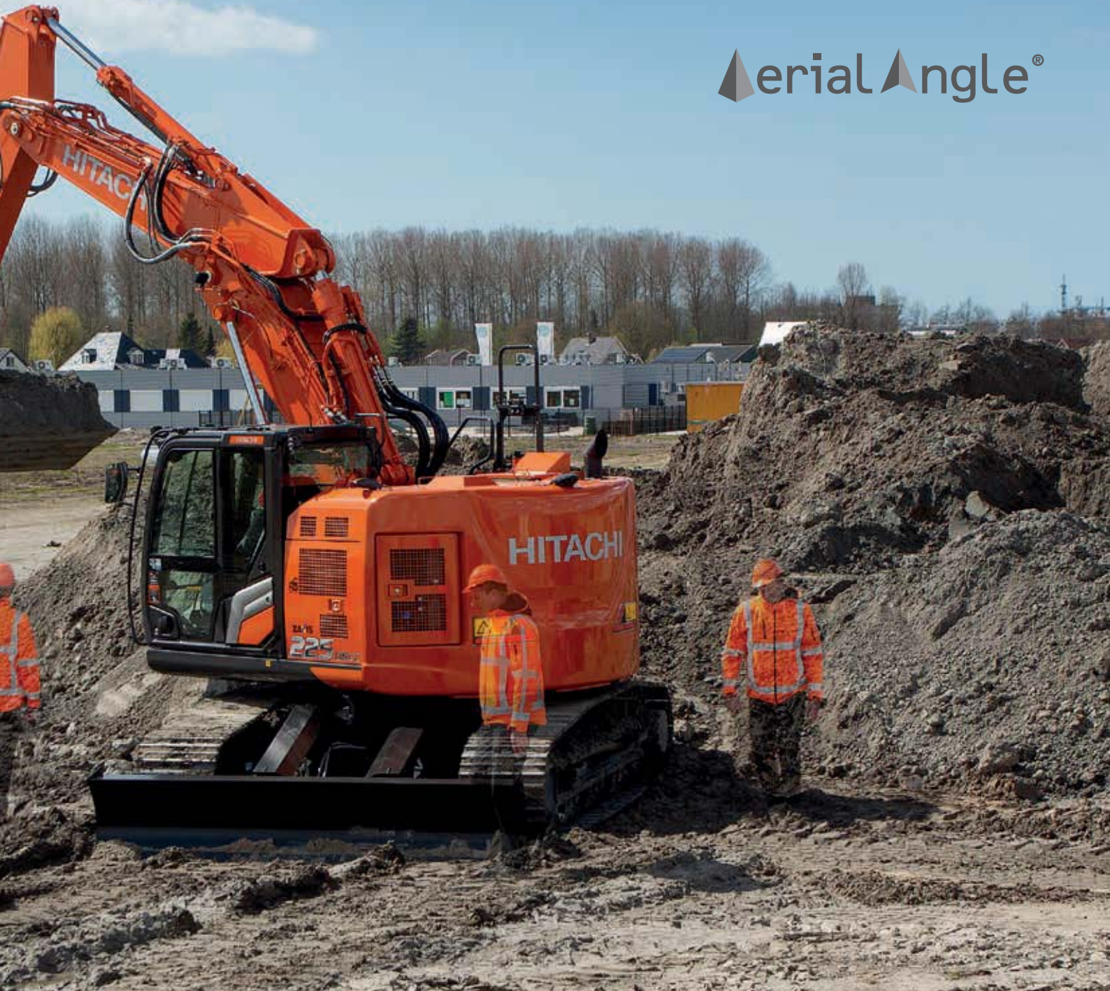
A 270 fokos látókört biztosító Aerial Angle kamerarendszerrel felügyelheti a biztonságos használatot.
