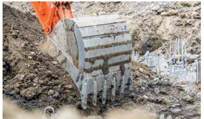
A Hitachi földmunkaeszközeihez önélező fogak és megbízható adapterek is tartoznak, amelyek biztosítják a pontos illeszkedést.
