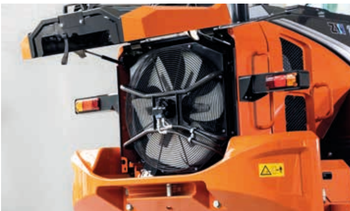
Az intelligens ventilátorüzemeltetési rendszer meggátolja a hűtők eltömődését.
