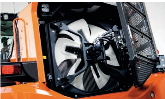
Az intelligens ventilátorüzemeltetési rendszer megátalja a hűtők eltömődését.
