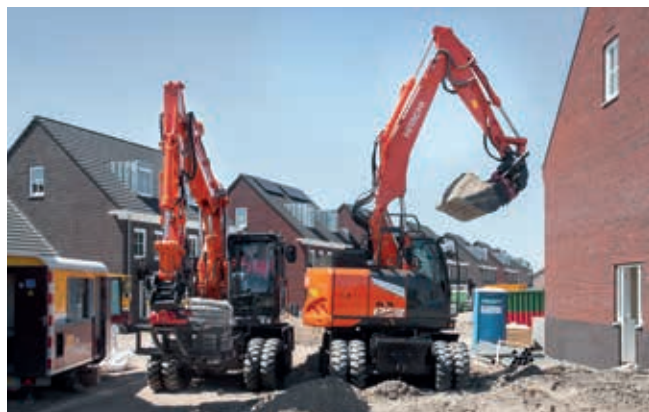
A ZX135W-7 fordulási sugara 3,5 méter (1 740 mm hátrafelé és 1 750 mm előre).
