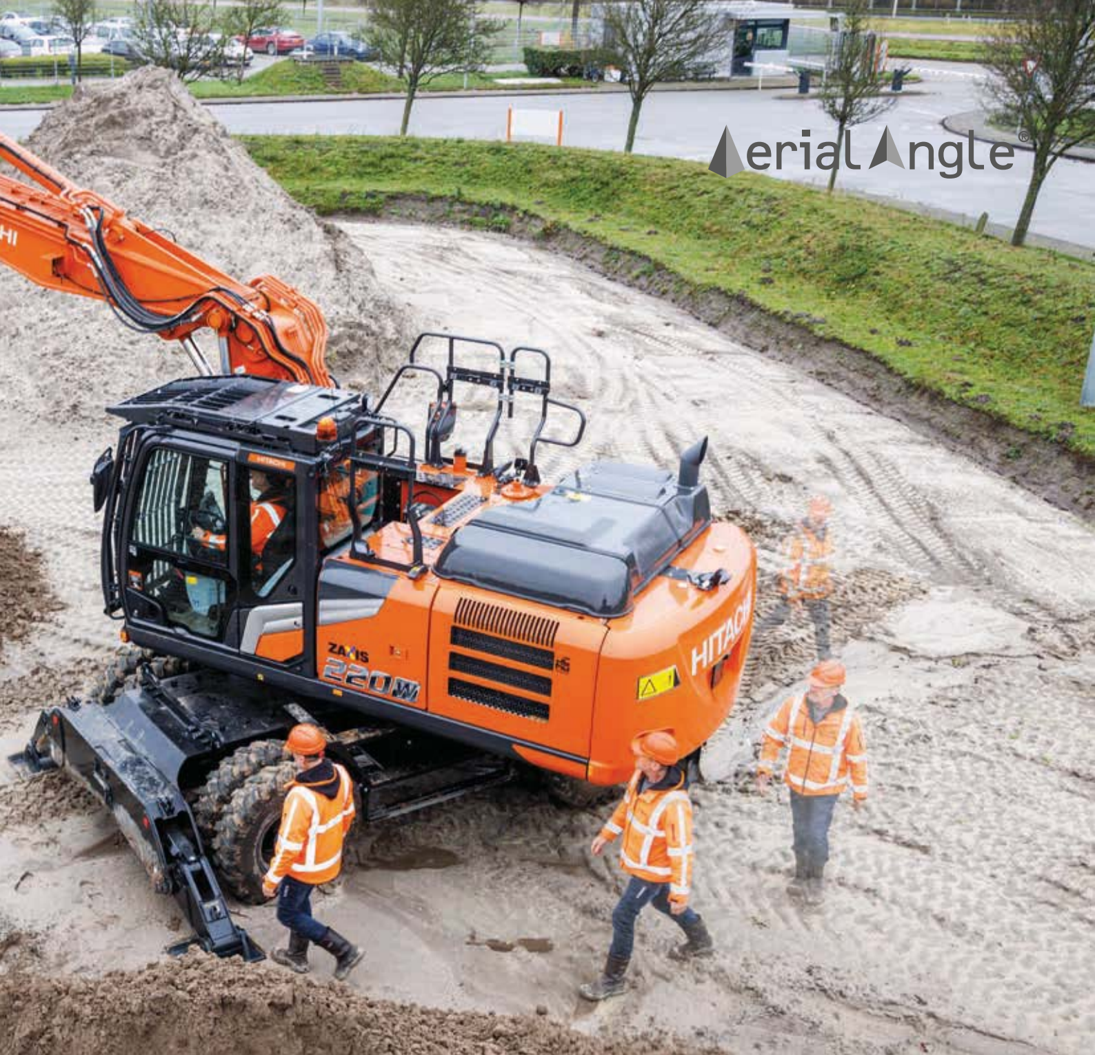
A 270 fokban látókört biztosító Aerial Angle kamerarendszerrel felügyelheti a biztonságos használatot.
